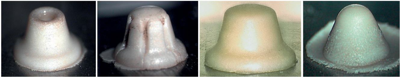
Bild 3. Variation verschiedener getesteter Nietkopfgeometrien im Projekt (von links nach rechts Form1 bis 4) (© KUZ)
